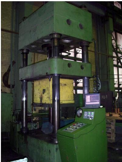
Гидравлический пресс ДО 436 с усилием прессования 400 тонн, предназначенный для изготовления деталей из тонколистового металла и пластмассы, изготовлен в 1970 годах. Состояние механического и гидравлического оборудования удовлетворительное, электрическое же оборудование в крайне плохом состоянии, причём, датчики положения утрачены, и пресс мог работать только в наладочном режиме.
